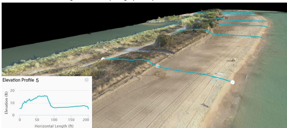
Figure 24 : Orthophotographie et profils en travers de la dune
